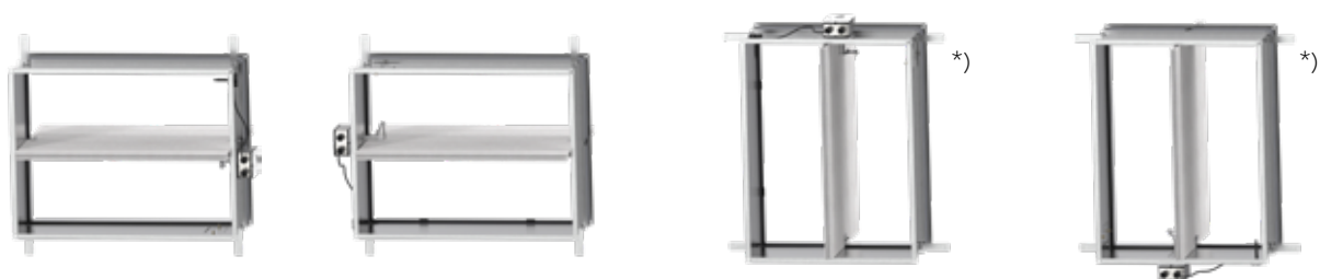
Obr. 17: Montážní polohy klapky FDS-3G a FDS-EI90/120S do stěny
